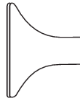
Trombeta – para fixação de chapas de gesso sobre perfis metálicos.
